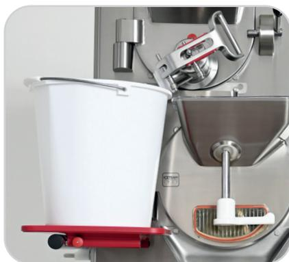
**Supporto laterale** - Nuovo sistema a scomparsa con altezza regolabile per sorreggere recipienti di grandi capacità. Il supporto permette di estrarre lateralmente la miscela in totale sicurezza e comodità.
