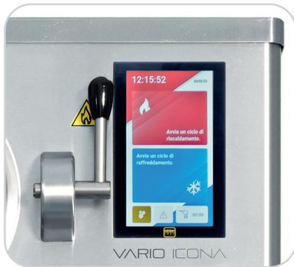
**Pastorizzazione** - Utilizzando la funzione "riscaldamento" si avvia un ciclo regolabile fino a 105°C. Le icone di comando sono di facile interpretazione; un segnale acustico/visivo avvisa quando la temperatura è stata raggiunta.
